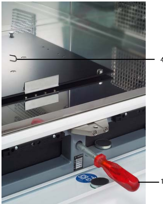
Abb. 9: Einstellen des Ausgleichsgewichts entsprechend der Beladung
